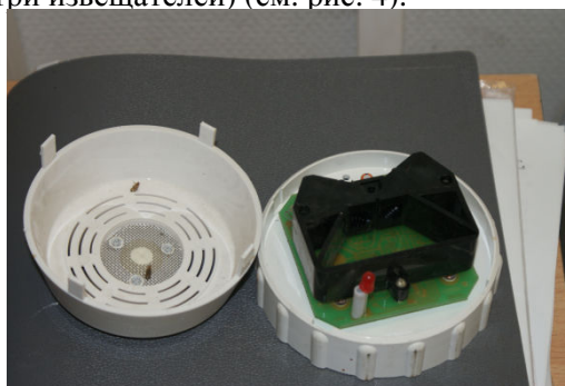
Рис. 4. Извещатель дымовой пожарной (внутри камеры извещателя видны насекомые)
